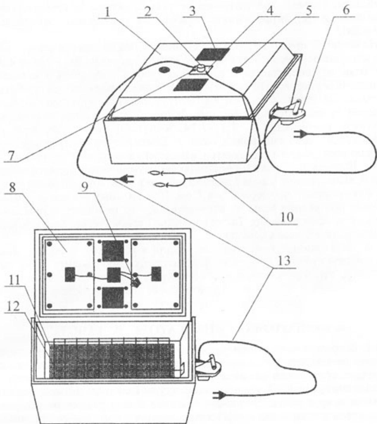
1- крышка; 2- ручка терморегулятора; 3- смотровое окно; 4- терморегулятор;
